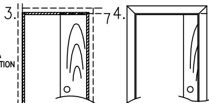
FINISH SPLIT HEADER CABECERA DIVIDIDA TERMINADA MONTANT DE SEPARATION FINITION
