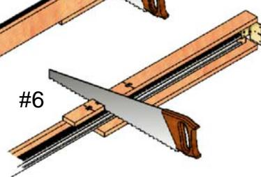
Para cortar la cabecera para puertas que no sean de un ancho estandar: Mida el ancho de la puerta y multipliquelo por 2. Súmelo 25mm. Marque la cabecera y córtelo (Paso #2). Corte el riel (Paso #3). Mida el ancho de la puerta. Súmelo 25mm. Marque la guía de la tabla del contramarco de la cabecera y córtelo (pasos #5 & #6).
