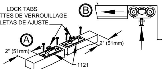
A/ Coloque la placa de la puerta 1121 sobre la puerta a 50mm de cada borde con las aletas de ajuste en el mismo lado.
